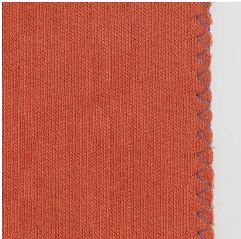
Le point de zigzag n° 2 convient pour tous les tissus. Il peut aussi être utilisé pour des coutures élastiques et des travaux décoratifs. Utiliser un fil fin de reprise pour les tissus fins. Pour la couture chenille, il est recommandé de régler un zigzag court dense, d'une longueur de 0,5 à 0,7 mm. La couture chenille peut être utilisée pour les appliqués et pour la broderie.
